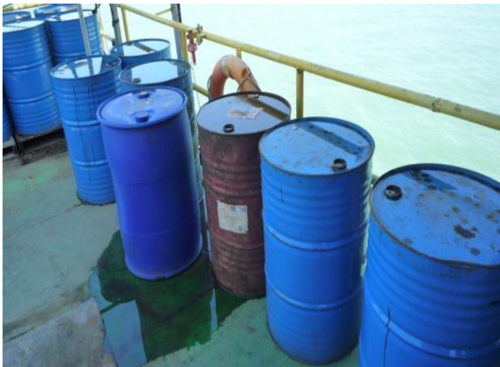
图 2-3 油品存放区无相应警示标志，部分油品直接放置在甲板上
