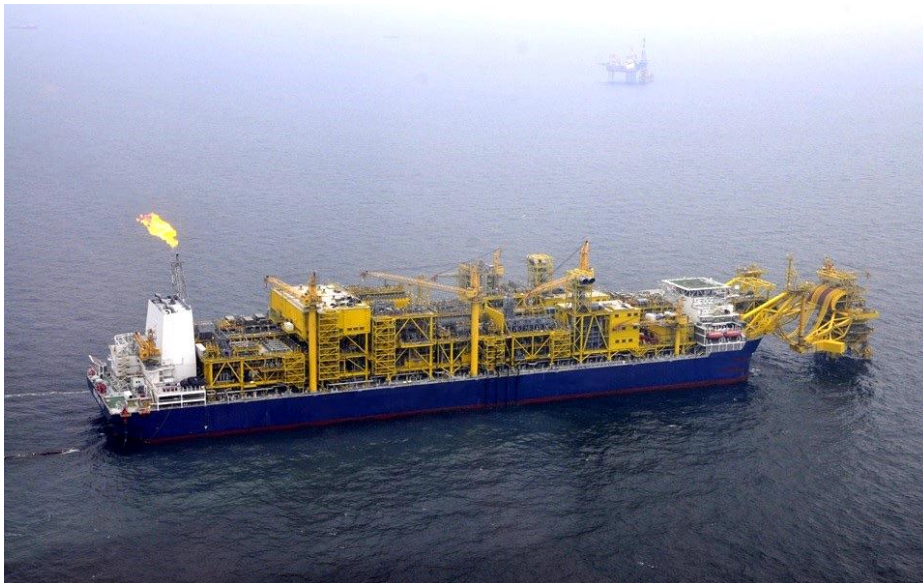
图 1-2 浮式生产储油装置和单点系泊
