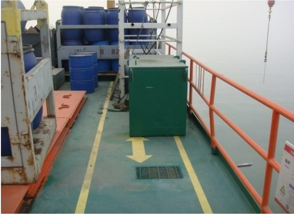
图 2-8 吊货甲板的逃生通道被阻挡
