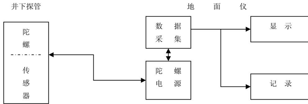
图 1 测斜仪结构框图
