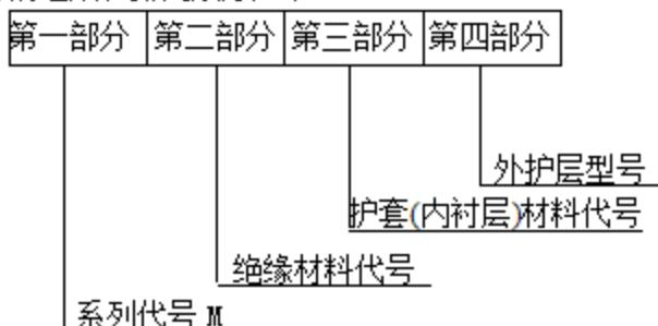
第一部分：用大写字母 M 表示煤矿用阻燃电缆的系列代号。
