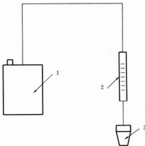
1——个体采样器主机； 2——流量计； 3——采样头。
