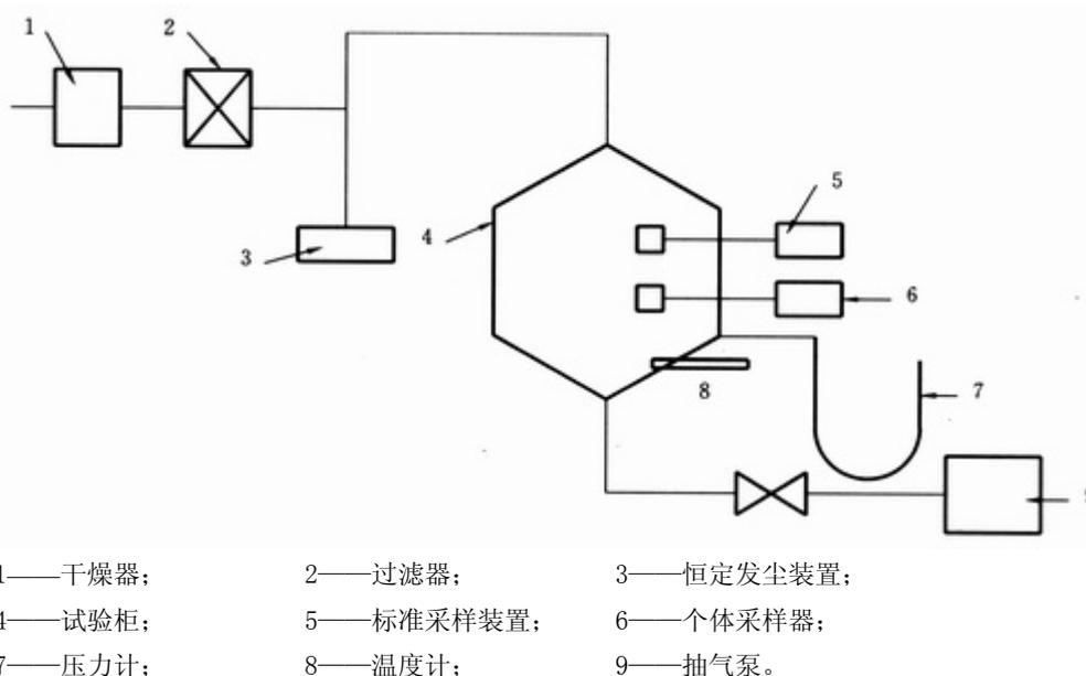
图4 测尘误差试验连接示意图
