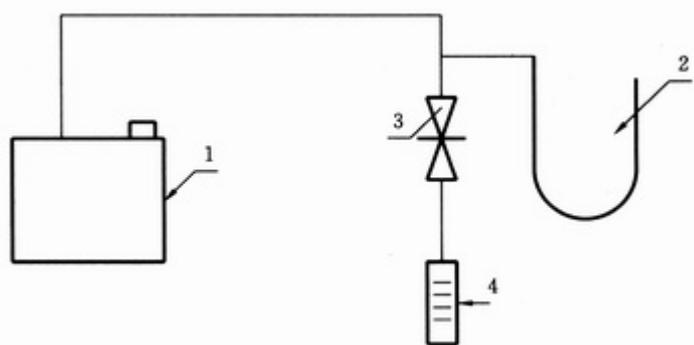
1——个体采样器； 2——压力计； 3——螺旋夹； 4——流量计。
