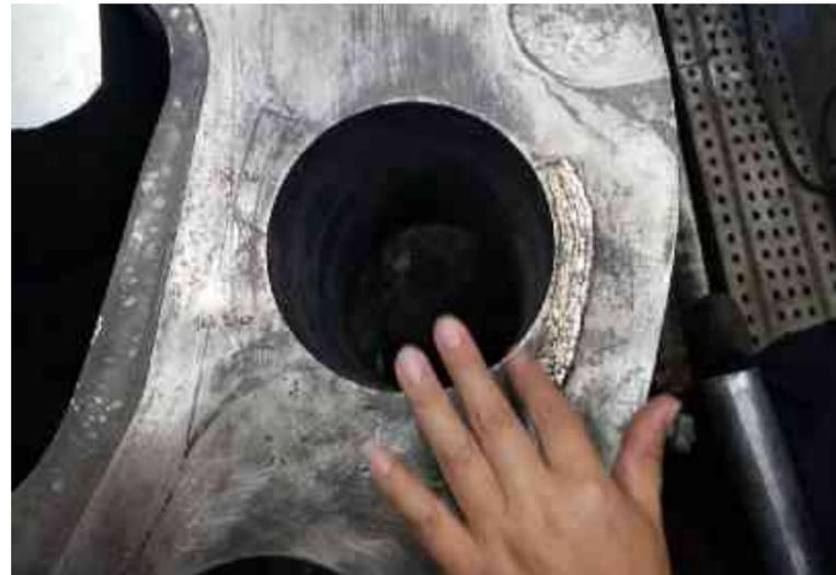
汽轮机中分面凹陷堆焊修复
