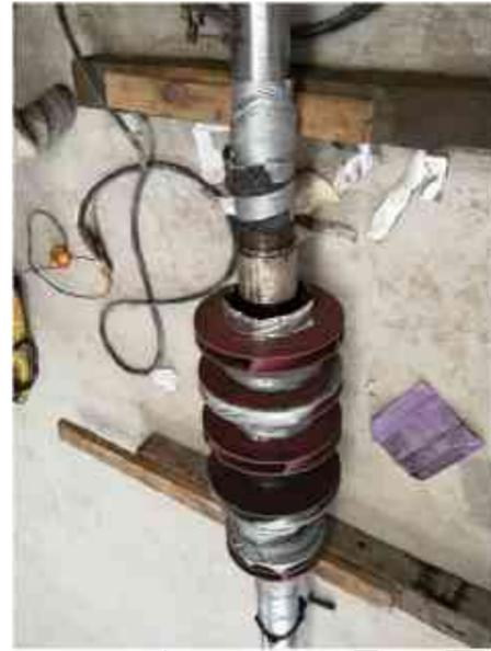
给水泵轴颈堆焊机加工修复
