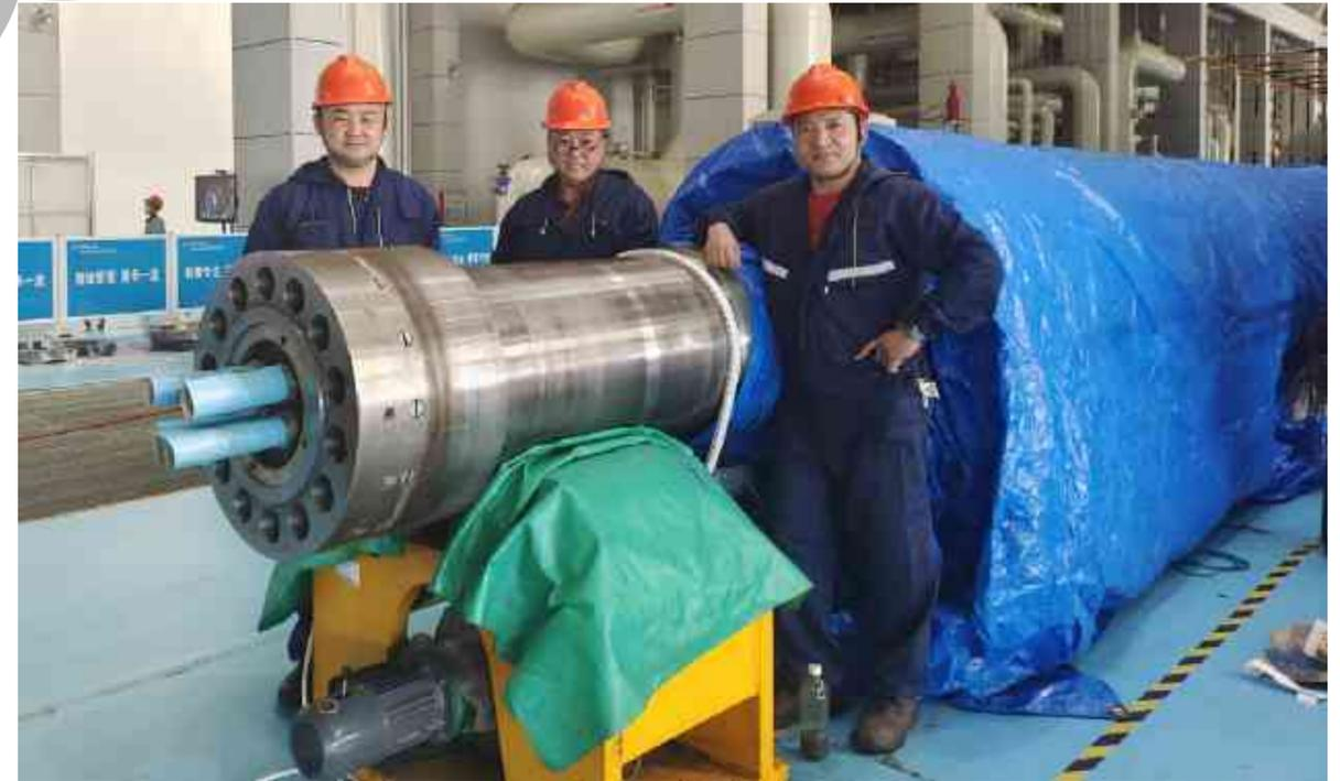
发电机转子轴颈拉伤堆焊打磨修复
