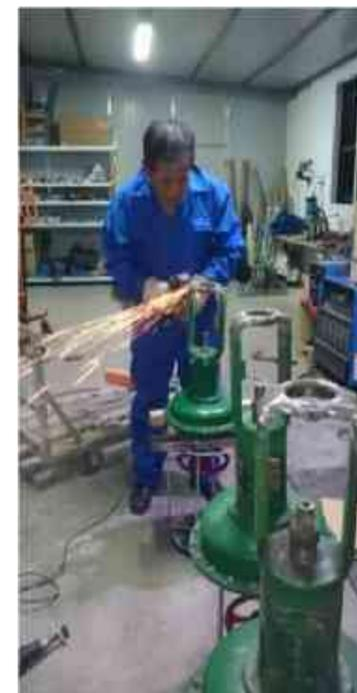
机架等铸铁类设备焊接修复
