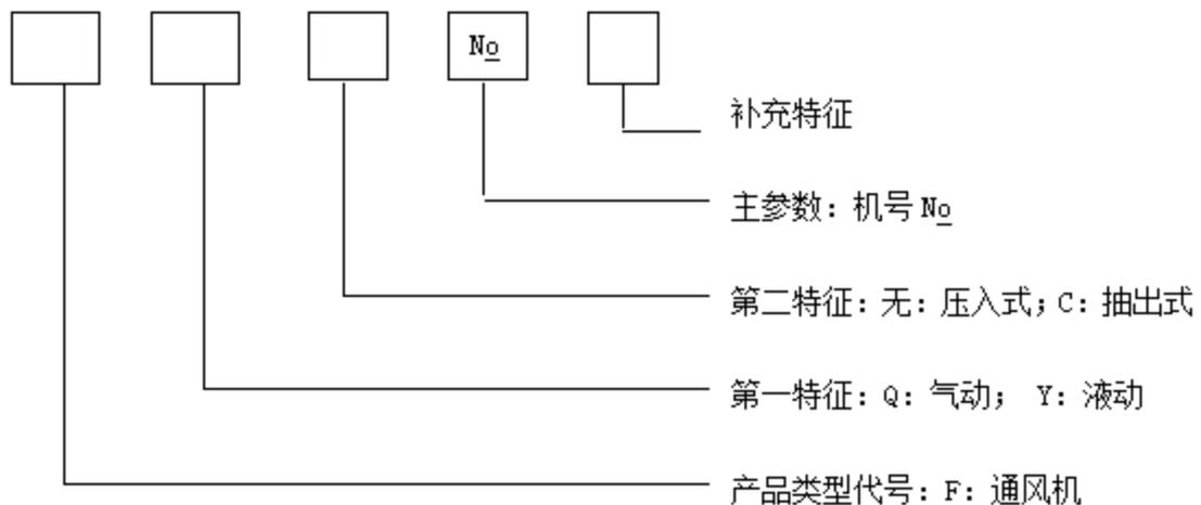
例：① FQC  $N_0$ 3.15：F 表示通风机，Q 表示气动，C 表示抽出式， $N_0$ 3.15 表示叶轮直径为 3.15dm，即 315mm。
