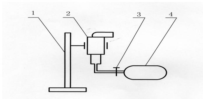
图2 有害气体气样收集系统示意图
