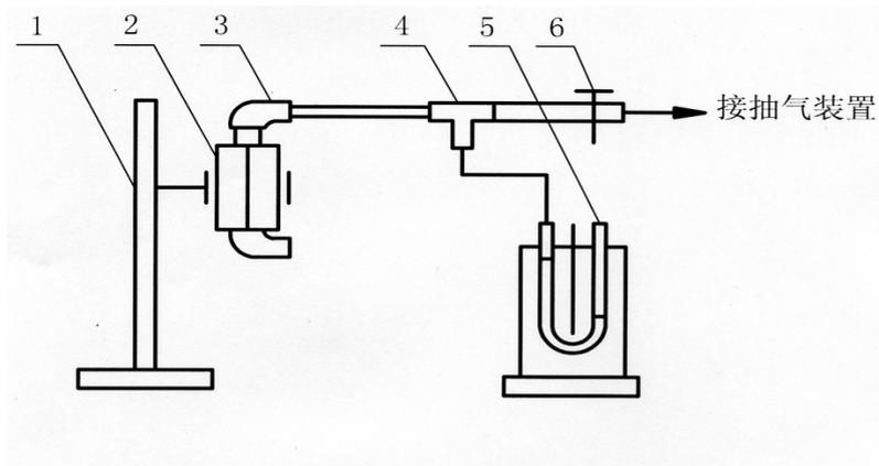
图3 整体密封性测定装置示意图
