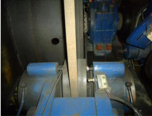
图 2-1 闸间隙保护缺失
