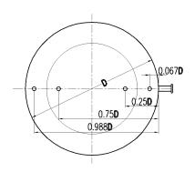
图A.3 采样点距管道内壁距离
