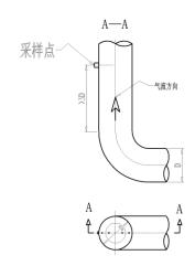
图A.2 圆形管道弯头后的测点
