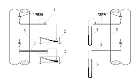
1—标准皮托管; 2—斜管微压计; 3—S型皮托管; 4—U型压力计; 5—管道 图A.4 动压及静压的测定装置
