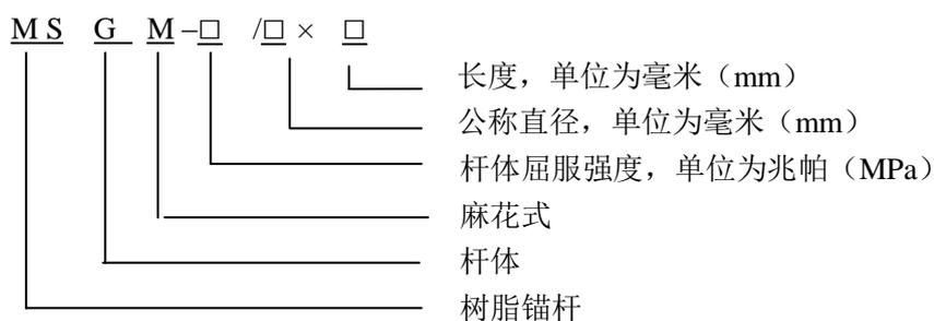
4.3.2 螺纹钢式树脂锚杆金属杆体型号表示方法如下:
