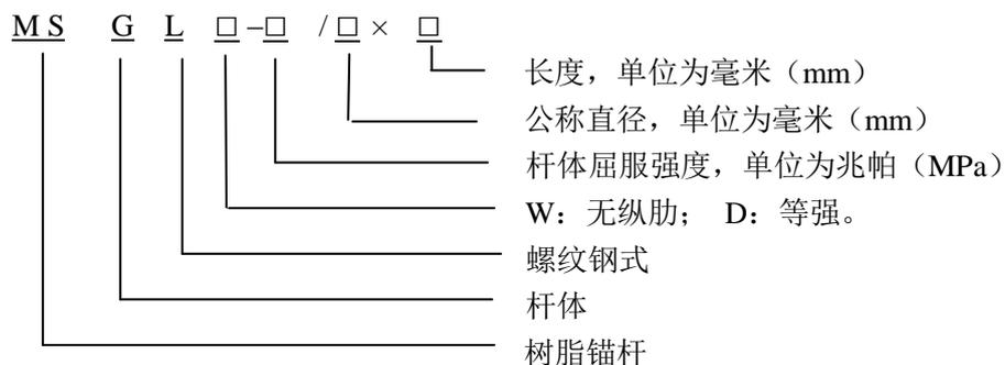
示例: 公称直径 20mm, 长度 2000mm, 屈服强度 335MPa 的无纵肋螺纹钢式树脂锚杆金属杆体, 可表示为 MSGLW-335 / 20×2000。
